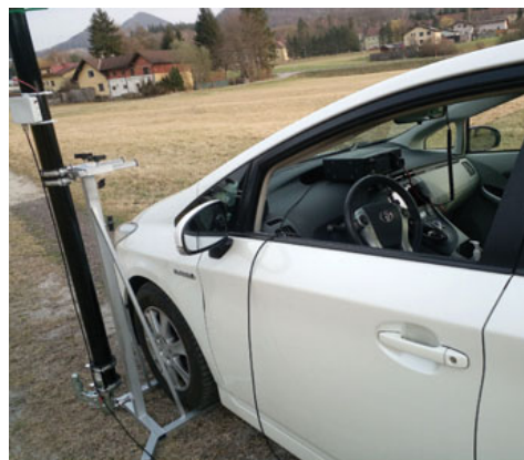
Bild 5 und 6: Der erste praktischen Aufbau – der Montagepunkt in 14 m Höhe trägt eine ZS6BKW (Dipol mit 4500 hm Zweidrahtleitung).
