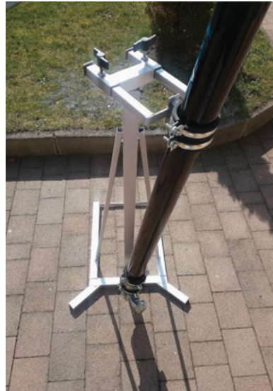
Bild 4: Der obere Montagepunkt ist dreh- und verstellbar und wird mit Knebelschrauben fixiert. Dadurch ist eine Anpassung im Gelände möglich.
