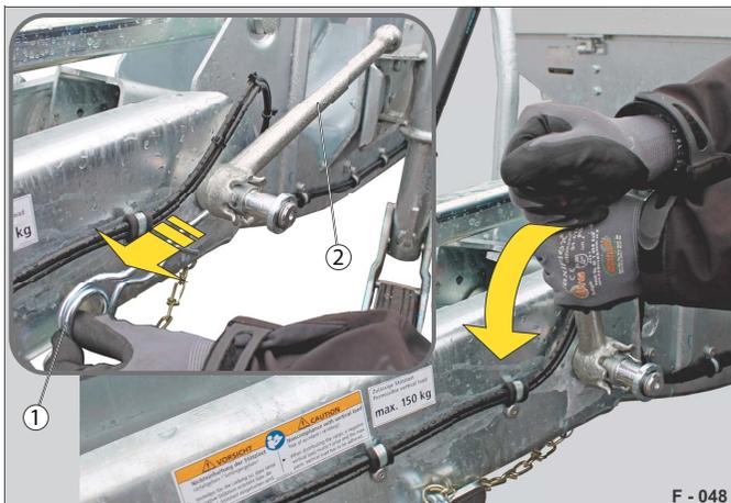
Abb. 46 Feststellknebel lösen
