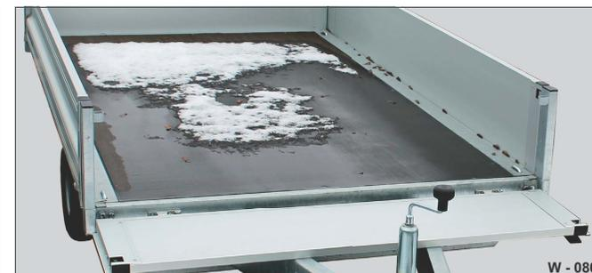
Abb. 89 Holz-Ladefläche / Mehrschichtholzplatte
