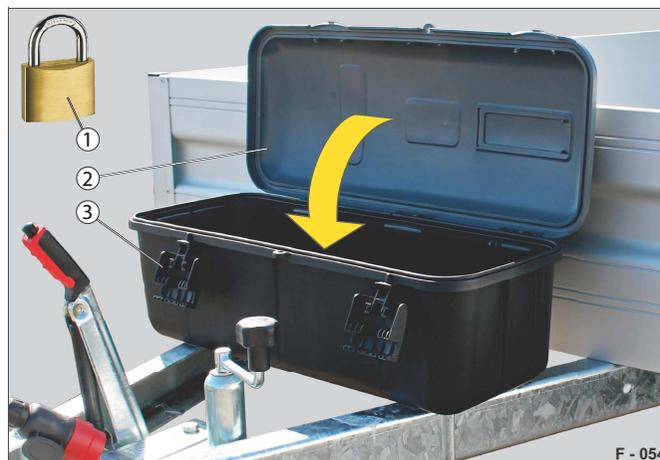
Abb. 80 Werkzeugkasten geöffnet
