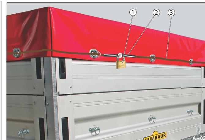
Abb. 60 Zollseilsicherung als Diebstahlschutz
