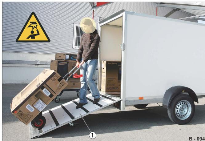
Abb. 35 Überfahrwand bedienen
