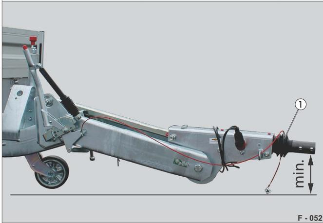
**Abb. 49** HV-Deichsel minimal Höhe
