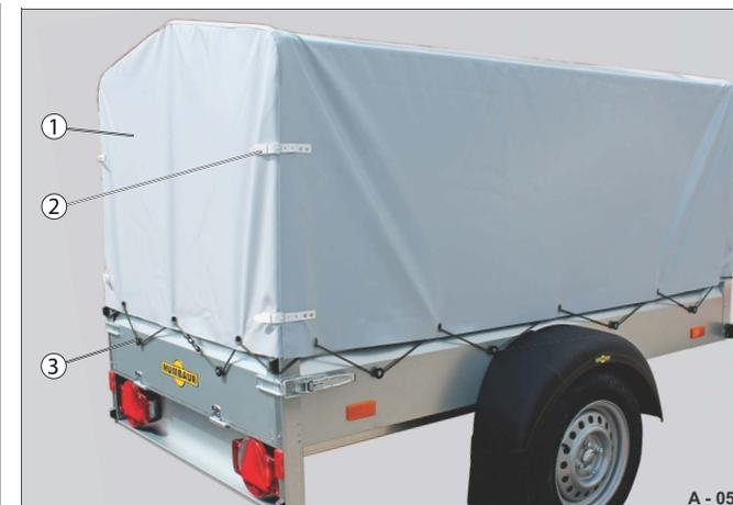
**Abb. 63** Sicherung Schnalle / Expanderseil
