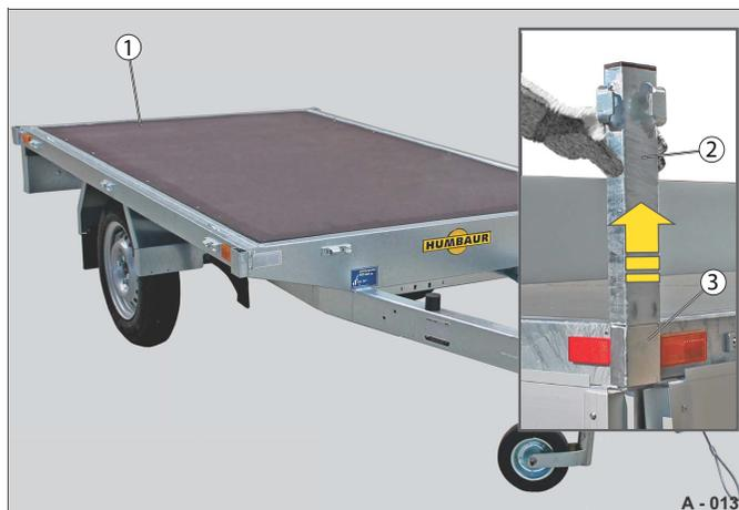
**Abb. 14** Bordwände demontiert, Eckrunge ausgesteckt
