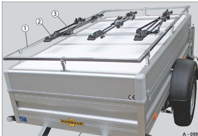
Abb. 95 Fahrradträger montiert
