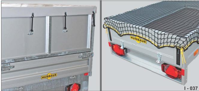
Abb. 47 Flachplane auf Aufbauten / Abdecknetz
