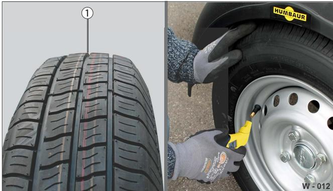
Abb. 14 Reifenfülldruck kontrollieren
