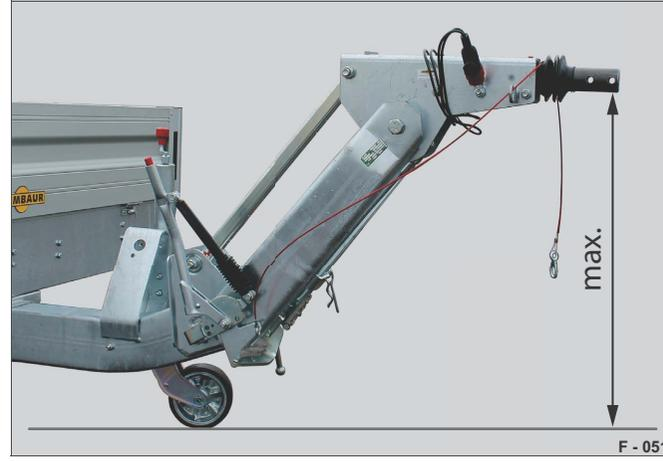
**Abb. 50** HV-Deichsel maximal Höhe
