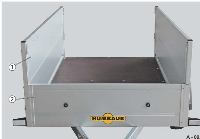
**Abb. 26** Heckbordwand / Bordwandaufsatz demontiert
