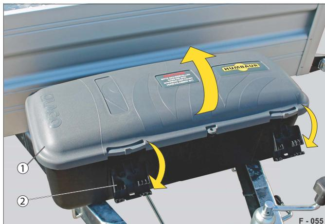
Abb. 79 Werkzeugkasten entriegeln
