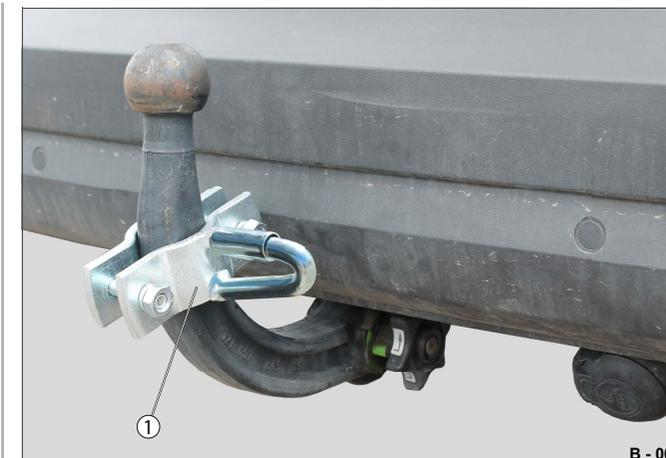
**Abb. 6** Beispiel: Klemmvorrichtung an der Kupplung
