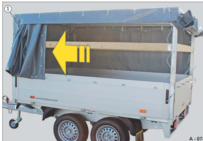
Abb. 85 Rückwand / Schiebeplane geöffnet
