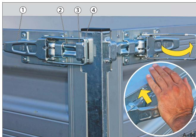
Abb. 6 Spann-Verschluss (HU, HUK, HT, HTK)
