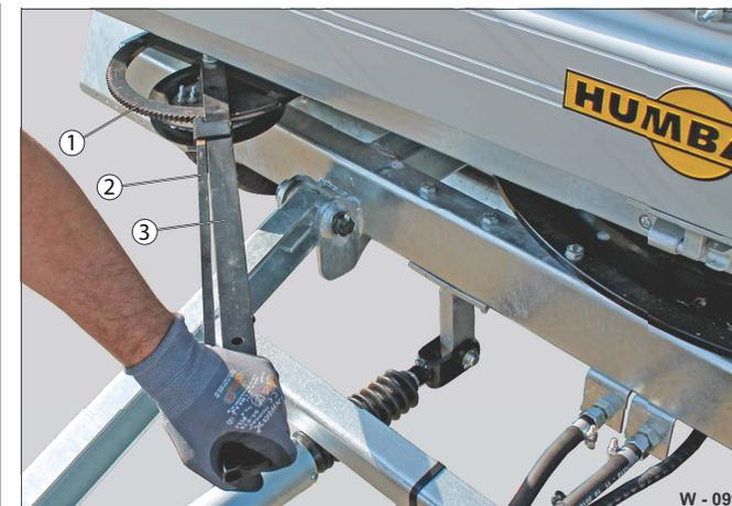
Abb. 57 Drehkranz-Bremse Schmierstelle
