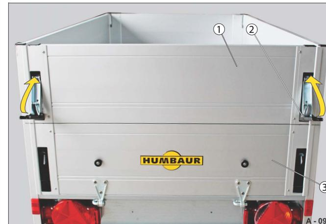
**Abb. 27** Hinteren / Vorderen Bordwandaufsatz montieren
