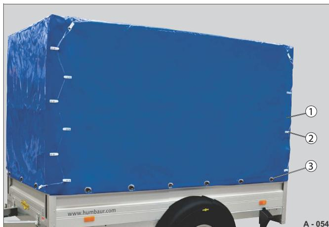
**Abb. 61** Sicherung mit Schleuderseil / Krampen
