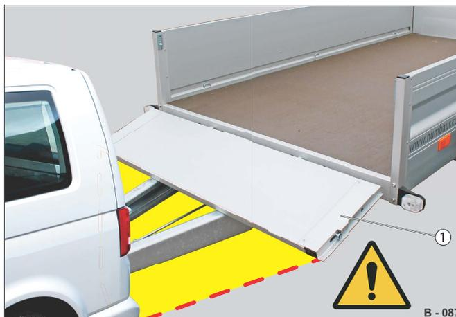
**Abb. 24** Fahren mit geöffneter Stirnbordwand
