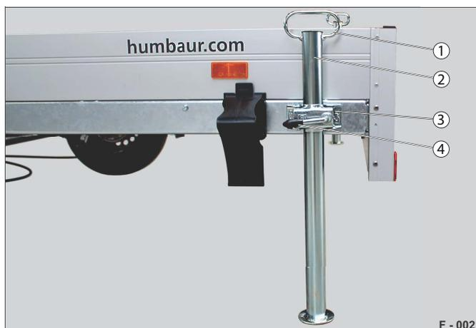
Abb. 25 Schiebestützen (Stützstellung)
