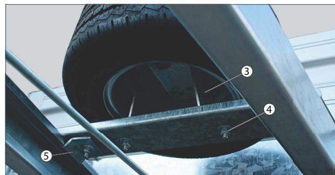
Abb. 18 Befestigung des Ersatzrades
