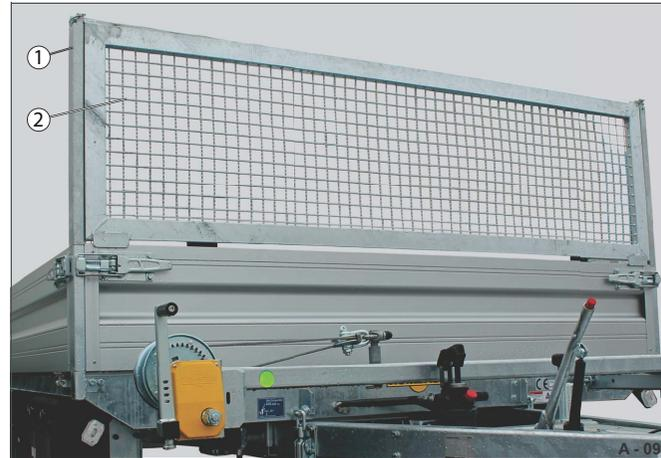
Abb. 29 Stahlgitter-Aufsatz
