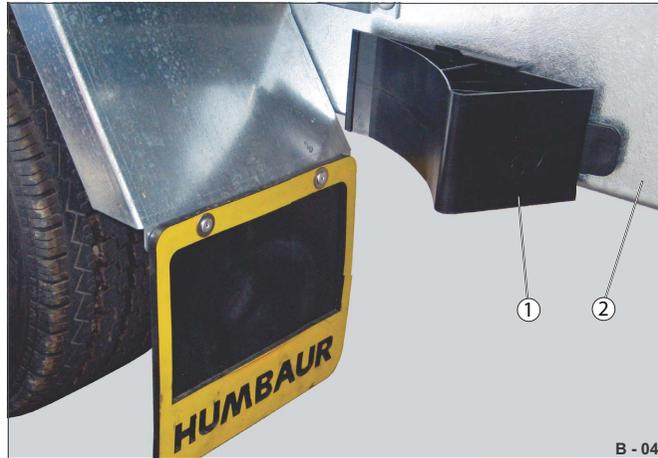
**Abb. 78** Beispiel 2: Unterlegkeile waagrecht seitlich
