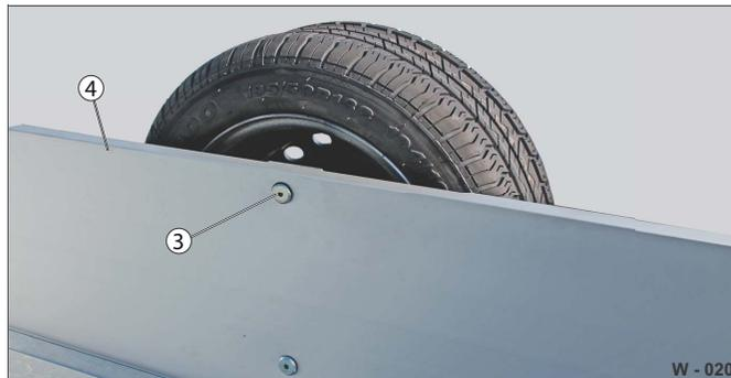
Abb. 22 Befestigung des Ersatzrades
