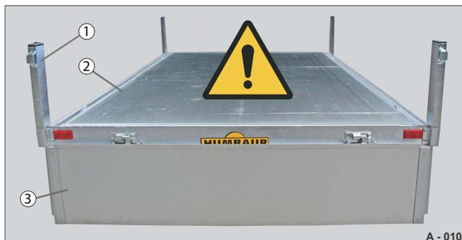
Abb. 2 Ungesicherte Bordwände / Eckrunge
