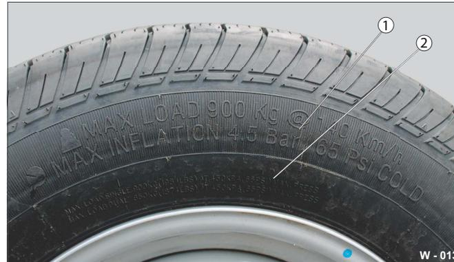
Abb. 15 Reifenfülldruck - Angaben
