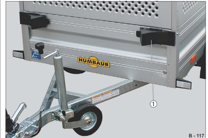
**Abb. 80** Beispiel 4: Unterlegkeile stirnseitig, nachgerüstet
