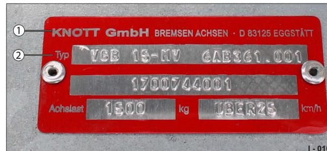
Abb. 24 Beispiel: Typenschild Knott-Achse, ungebremst
