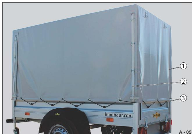
**Abb. 62** Sicherung mit Riemenband / Expanderseil
