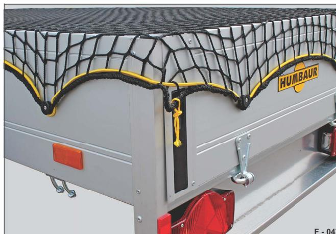
Abb. 105 Abdecknetz gespannt
