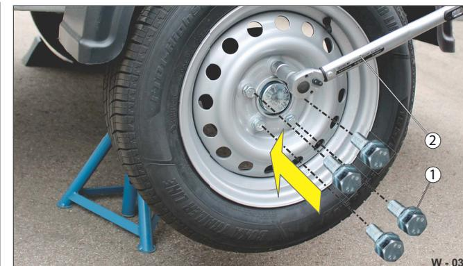
**Abb. 32** Ersatzrad montieren
