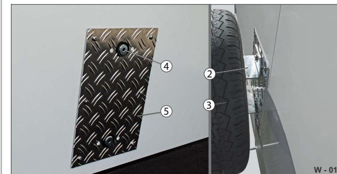
Abb. 20 Befestigung des Ersatzrades
