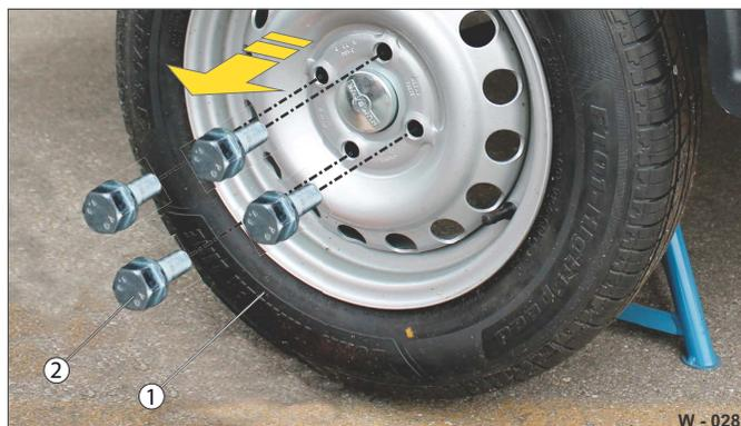
**Abb. 30** Defektes Rad abziehen
