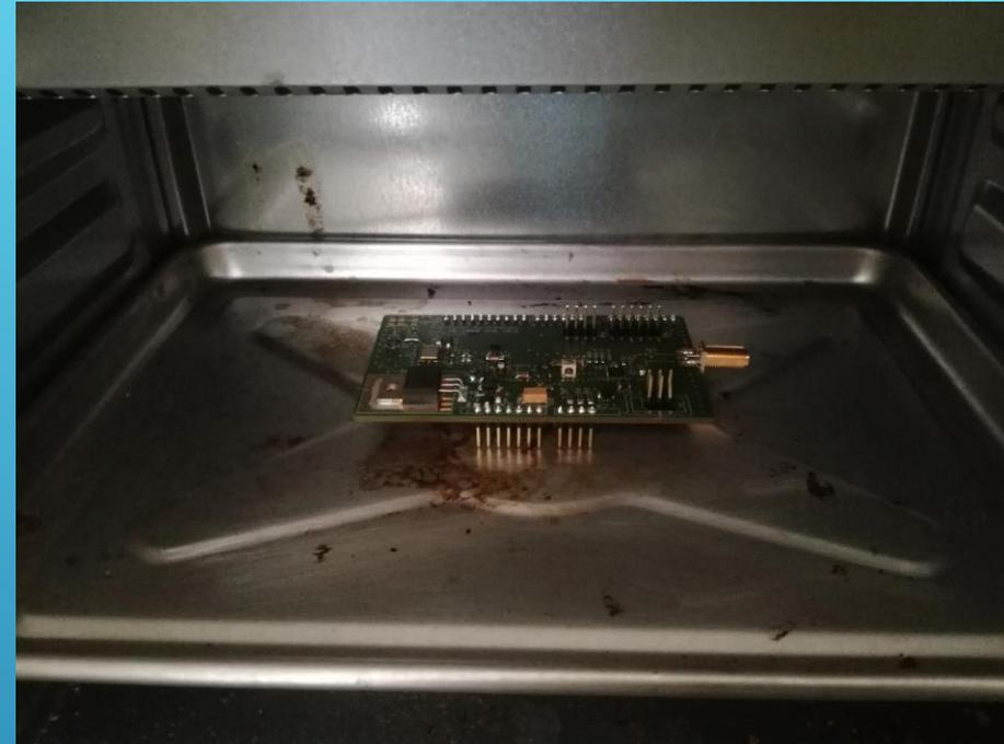
Anschließend werden die aufgebrauchten Bauteile auf das Aluminiumblech des Brotbackofens gelegt und die Temperatur des Ofens auf 220-230° C eingestellt. Nach ca. 3-7 Minuten beginnt die Lotpaste zu schmelzen, das enthaltene Flussmittel zu fließen, und bildet einen homogenen, metallischen Meniskus um die Anschlüsse und die Lot-Pads.
