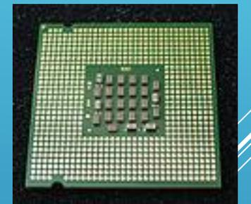
Schachbrettartig angeordnete LGA-Kontaktflächen unter dem Gehäuse eines Mikroprozessors
