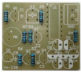
2. Einlöten der Kondensatoren C1, C2, C3, C5:
