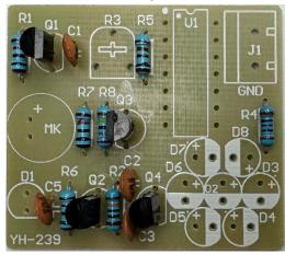
4. Einlöten des IC-Sockels (auf Kerbe achten – siehe gelber Pfeil im Bild), des Trimmpotentiometers und des Mikrofons:
