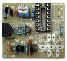
5. Einlöten der Infrarot-Empfängerdiode und der roten LEDs (auf Polarität achten – der lange Draht der LEDs ist die Anode (+)):
